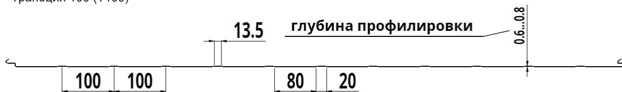
Рисунок 18. Виды профилировки наружной стороны сэндвич-панелей ПСТ Z
