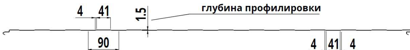
Рисунок 18. Виды профилировки наружной стороны сэндвич-панелей ПСТ Z
